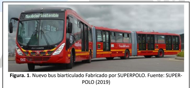
Las empresas ensambladoras realizan un esfuerzo tecnológico importante en el diseño de carrocerías para la fabricación de éstas utilizando por ejemplo chasis pertenecientes a las empresas Scania y Volvo. El chasis Scania es propulsado por un motor a gas natural y cumple con los niveles de emisiones determinados en la norma europea de emisiones Euro VI. Los chasis Volvo cuentan con motores diésel con tecnología Euro V de fábrica, aunque se le adiciona un catalizador o filtro que
