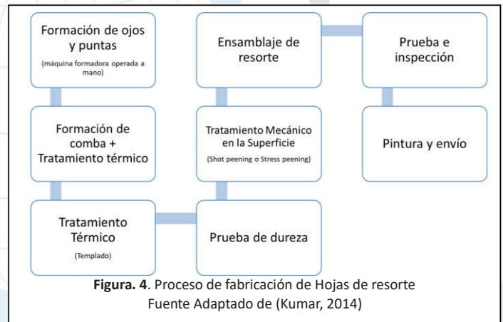
Figura. 4. Proceso de fabricación de Hojas de resorte
