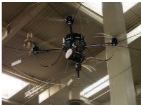
Figura. 1. Ejemplo de UAV con cuatro rotores (de uso académico). Fuente: (Valavanis & Vachtsevanos, 2015)
